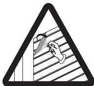
[C000388] Poista suojakalvo ovilevyn metallipinnasta heti asennuksen jälkeen.
