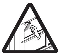
[C000391] Après le montage du portail il faut directement retirer le film de protection de la surface de la verrière.
