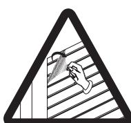
[C000388] После установки ворот следует немедленно снять защитную пленку с металлической обшивки створки.
