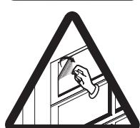
[C000391] Verwijder na het monteren van de poort onmiddellijk de beschermfolie van het glasoppervlak.
