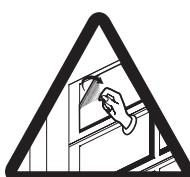
[C000391] После установки ворот следует немедленно снять защитную пленку с поверхности остекления.
