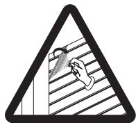
[C000388] Après l'installation de la porte, le film de protection doit être immédiatement retiré du battant.
