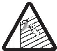
[C000388] Verwijder na het monteren van de poort onmiddellijk de beschermfolie van de staalplaat op het poortblad.
