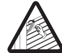
[C000388] Aftag beskyttelsesfilmen fra dørpladens metalbeklædning straks efter installation.
