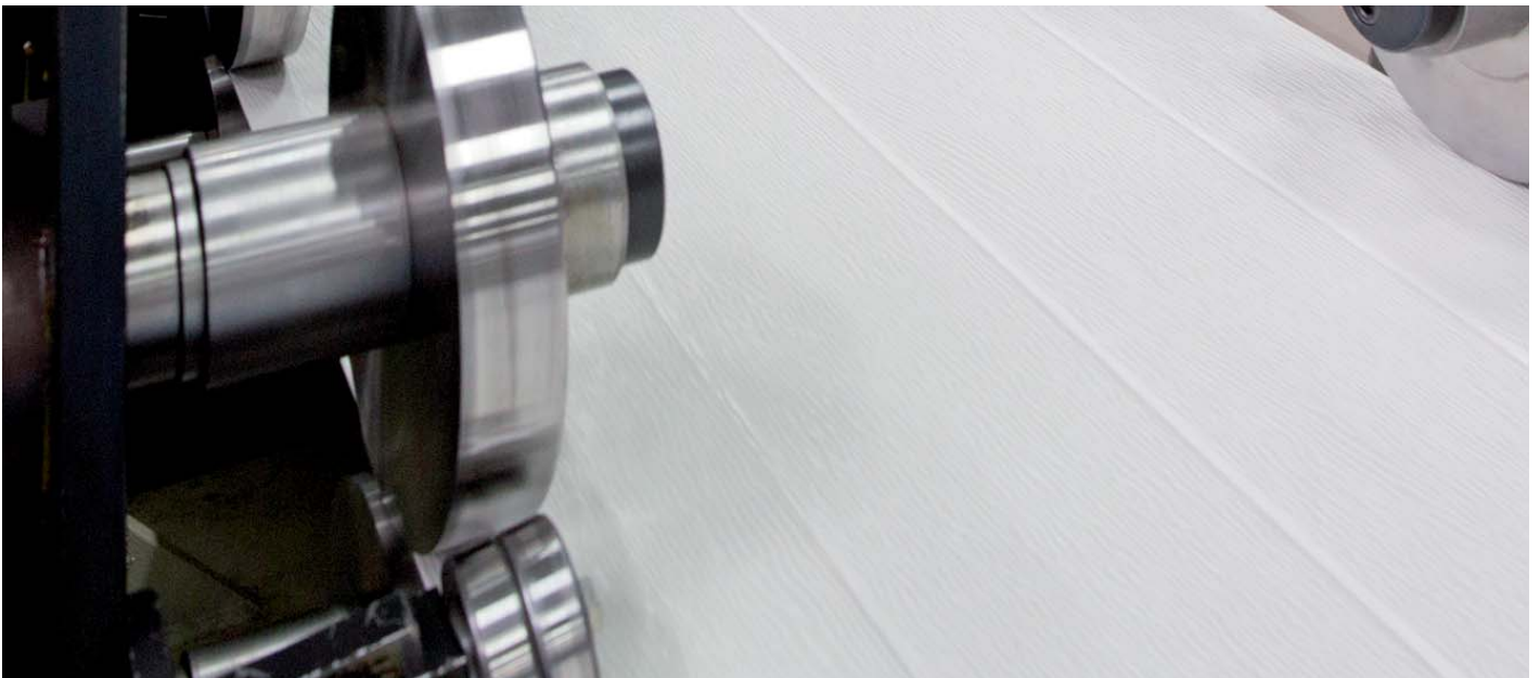
Meer dan 200 m lange moderne, computergestuurde technologische lijn waarin volgens een continu procédé sectionaalpoortpanelen worden vervaardigd – op de foto's één van de plaatvormfases.
